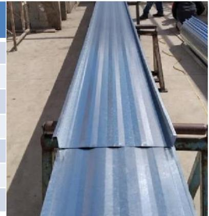
Centrolam SSA es una cubierta metálica con ondas de 2" de alto, mayor ancho de onda (3/4") y con ambas ondas completas. Esto significa una mejor onda y más metal en el solape, lo cual le da mayor resistencia mecánica e impermeabilidad. La onda completa además permite hacer pantallas, valladas y cielo rasos colgantes.
